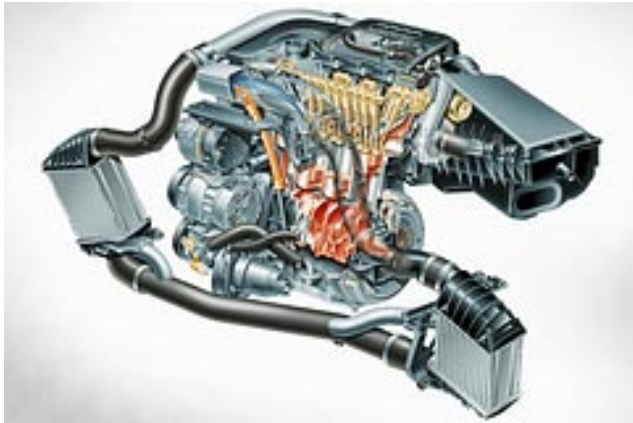
Schnitt durch den meistgetunten Benzin-Turbomotor (Audi 1.8 T): Tuner wollen bis zu 300 PS herausholen.
